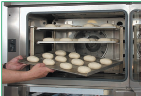
Ladenbackofen als Umluftofen beim Brötchenbacken
